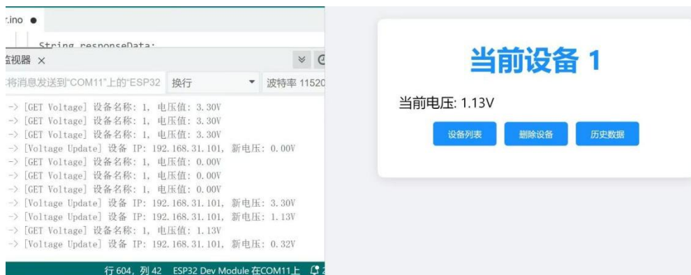
图 5 工业物联网电压监测系统软件部分调试
