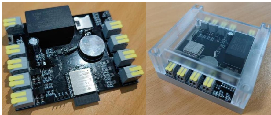
图 4 工业物联网电压监测系统硬件部分产品
